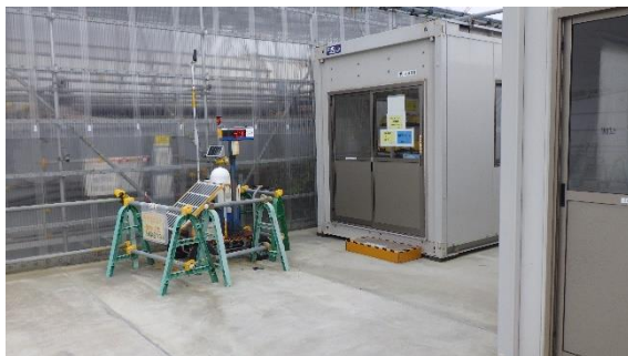
(写真1-2) 線量表示器設置状況② (3, 4号機海側)
