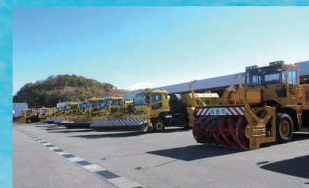
除雪車庫 滑走路、誘導路、エプロン等の雪を除去する機械を格納しておく建物で、ロータリー車2台、スノーバー車5台、プラウ4台、凍結防止剤散布車2台の計13台を配備しています。
