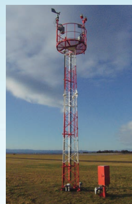
風向風速計 航空機離着陸付近の風向・風速を観測する装置です。
