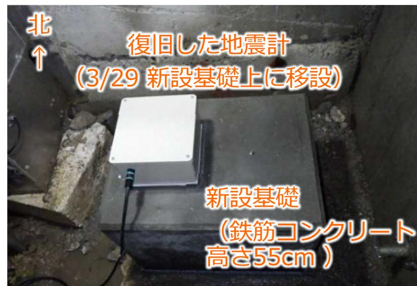
1階地震計 3月29日 新設基礎への移設状況
