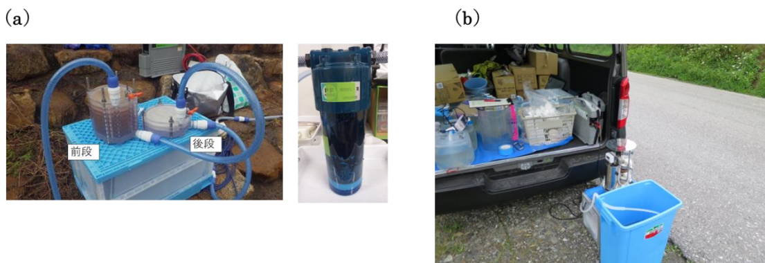
図2. 放射性セシウム回収装置 (a)多段ろ過装置 (b)放射性セシウムモニタリング装置
