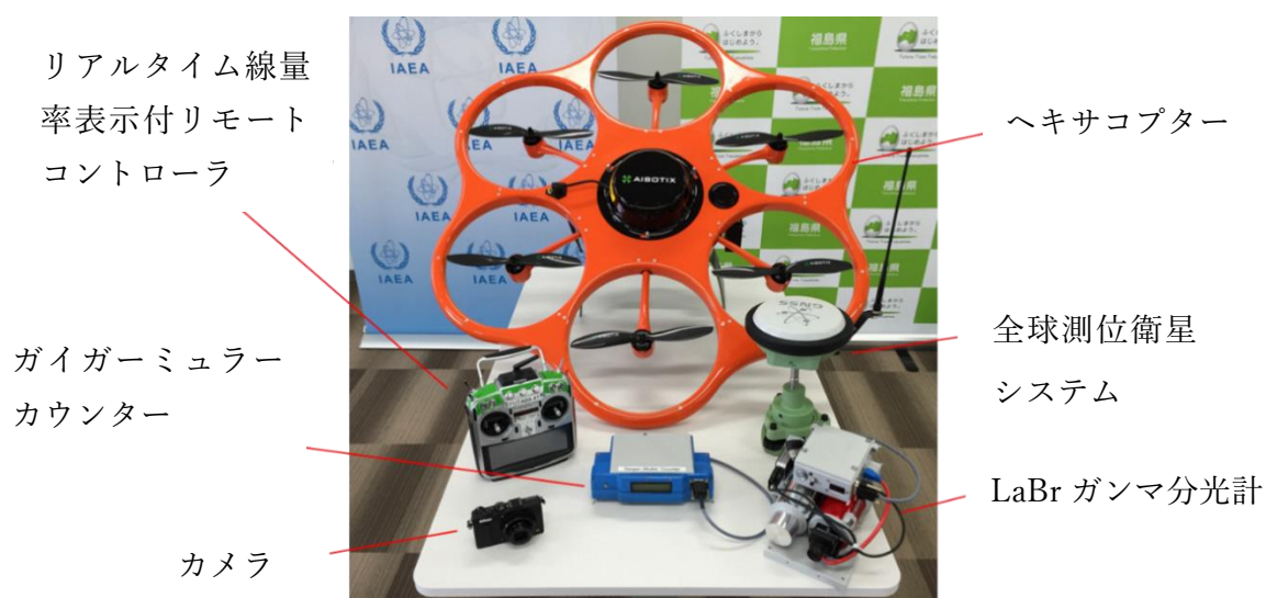
図 5.1 県に納入された UAV ベースのシステムと計装機器（提供：IAEA）
