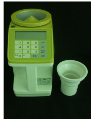
図2 水分計の例 (PM-830-2、Kett)
