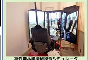
高性能林業機械操作シミュレータ
