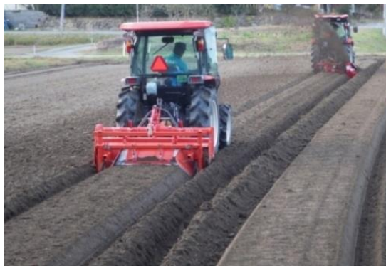
図 6-1 畝立て（図中左）と 畝間明渠（図中右）
