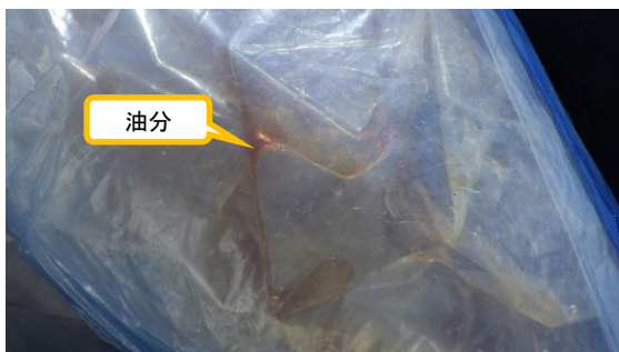
(写真3-3) 静電気防止袋内の状況 ウエスから油分が染み出している
