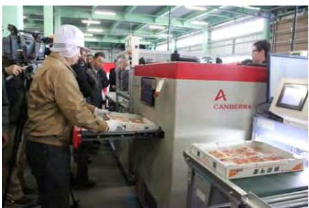
世界初のアんぼ柿非破壊検査機器
