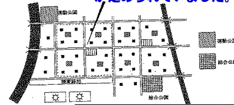
総合公園 縦横距離10～50ha 運動公園 縦横距離15～25ha 街区公園 敷地面積1～2ha ※都市の実状に応じて配置
