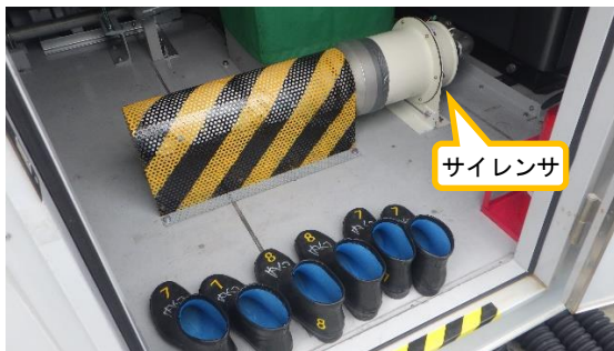
(写真 2 - 3) 改造されたサイレンサ (不具合発生時は窒素ガス分離装置 内に設置されていた。)
