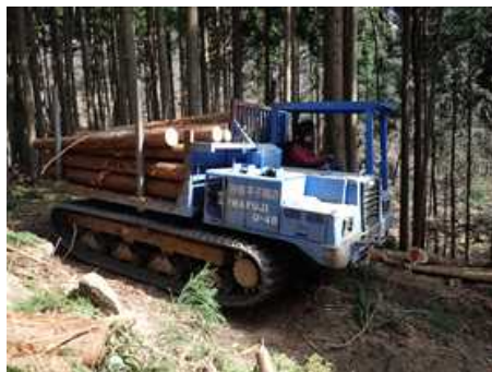
作業路を利用した間伐材の搬出
