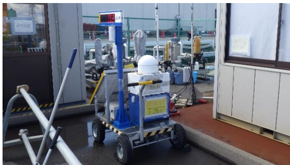
(写真1-1) 線量表示器設置状況の一例 (4号機南側法面)
