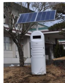
▲村内各所に設置されたモニタリングポスト
