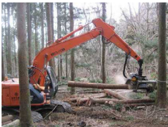
林業機械による間伐の様子
