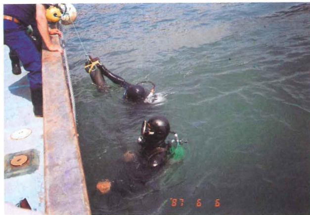
写真-4 ちり取り型採泥器による採泥
