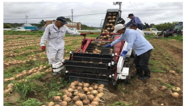
機械でタマネギを効率的に収穫
