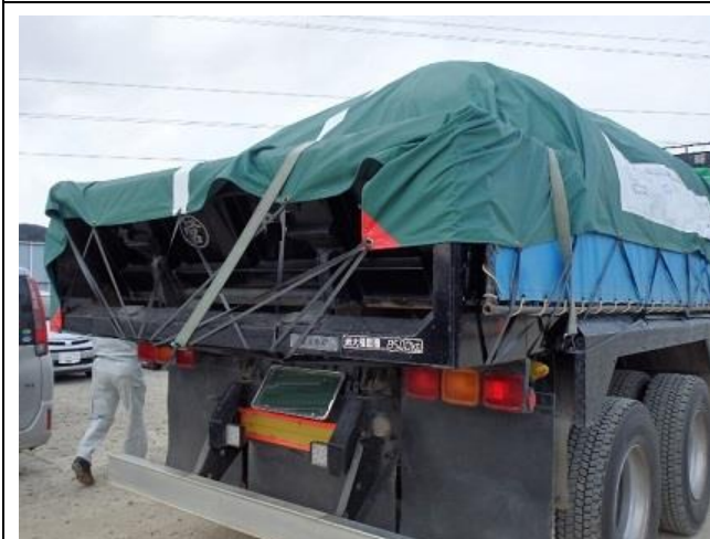
除去土壌等の飛散・流出防止対策
