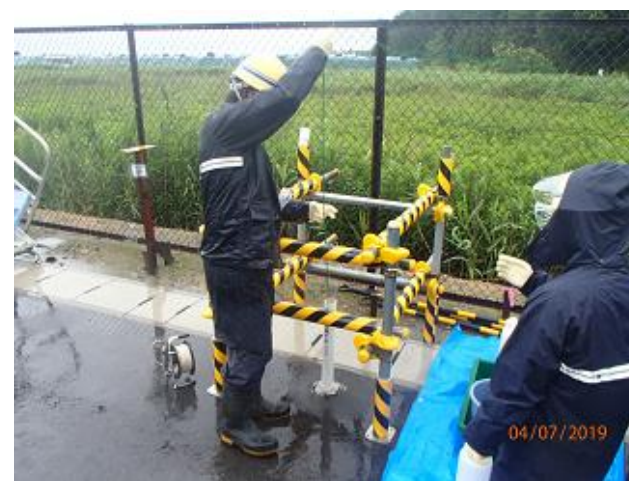
受入・分別施設地下水の測定
