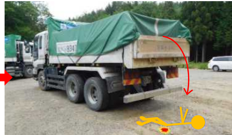
後部ゲートに掛けていた足が滑り、転落した。
