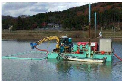
水中掘削器機による除去工法
