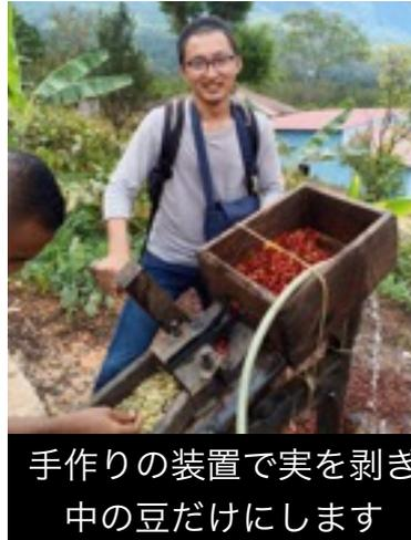
手作りの装置で実を剥ぎ中の豆だけにします
