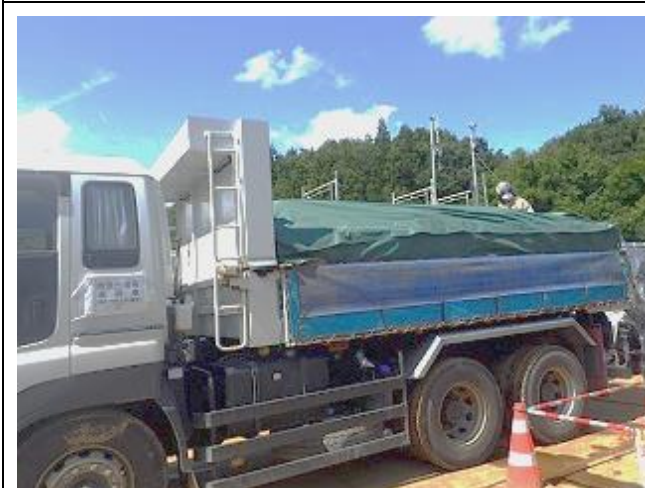
除去土壌等の飛散・流出防止対策
