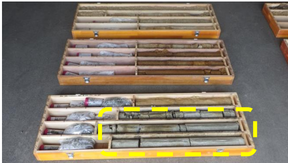
(写真2) 建屋を支持する地盤である富岡層 泥質部（泥岩）（黄粋部分）
