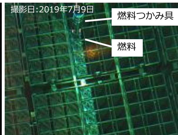
共用プールラックへ新燃料を収納
