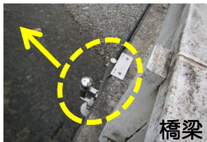
橋梁 浜野雨量水位観測局 超音波式水位計 (伊南川/福島県南会津町)
