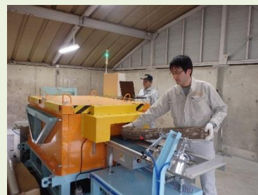
しいたけ原木の非破壊検査
