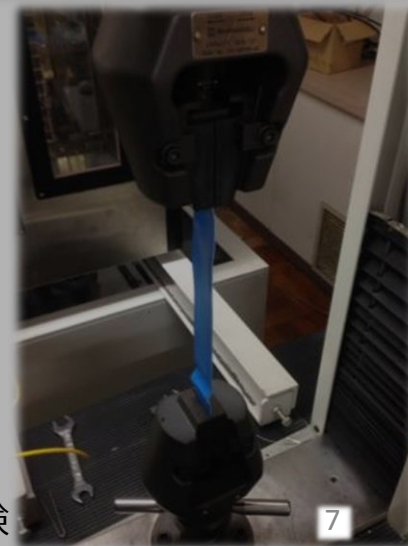
②部材の引張強度試験
