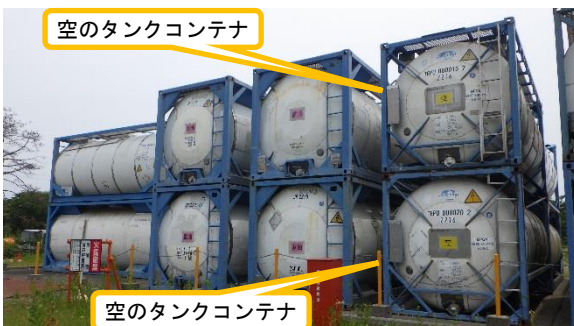
(写真 3-2) 空のタンクコンテナの保管状況
