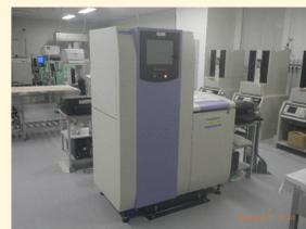
液体シンチレーションカウンタ（トリチウム）
