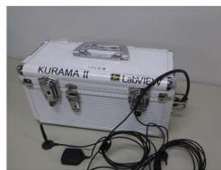
走行サーベイの装置（KURAMA II）。自動車に設置、走行することでルート上を測定できます。
