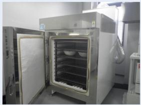
固体試料は灰化炉で濃縮
