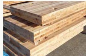
CLT 1枚約220kg (1m × 3m × 厚さ18cm)
