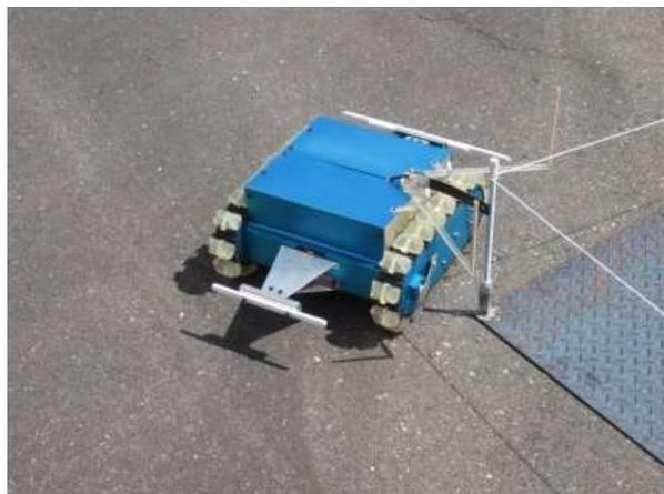
電気柵用除草ロボットのデモンストレーション
