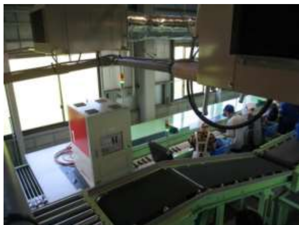
きゅうり計測部(カメラによる等階級判定)
