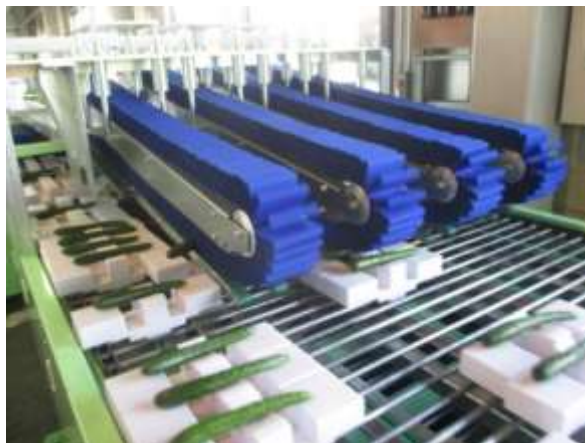
無落差無転倒方式による仕分け部
