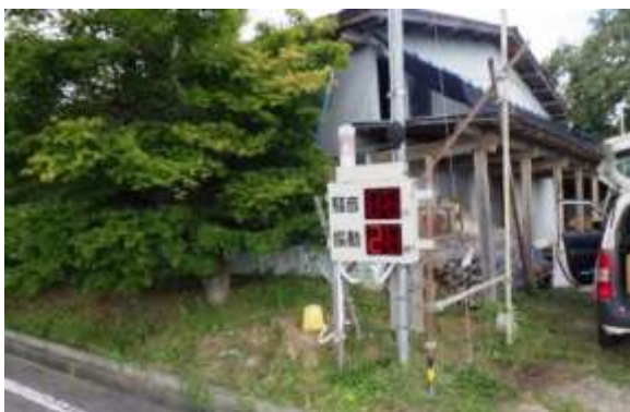
騒音振動計測器の設置
