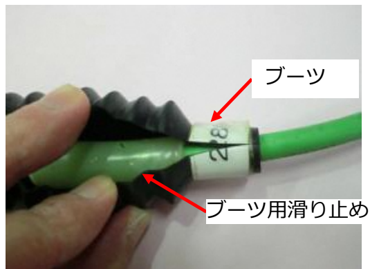
①ブーツ用滑り止めのずれ
