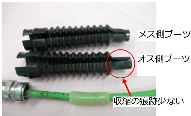
②ブーツの熱収縮状況
