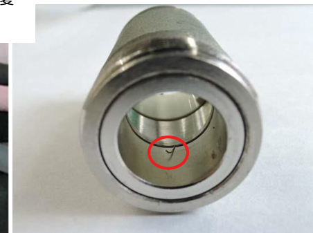
接続部内部のシールド線
