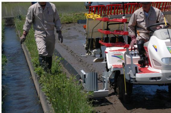
写真 専用機械による畦畔板の設置状況
