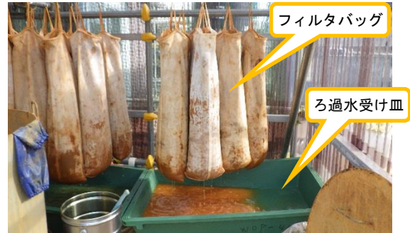
(写真 2 - 2) 汚泥の水切り、乾燥の状況
