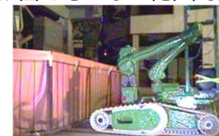
遠隔無人ロボットによる2号機オペフロ内の床面線量測定 (東京電力動画・写真ライブラリーより)
