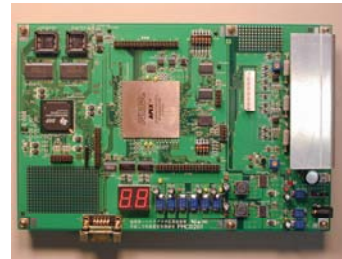
図2 32ビット浮動小数点DSPを用いたモータ制御方式評価装置
