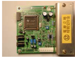
図1 1チップDSPを用いたモータドライブ回路
