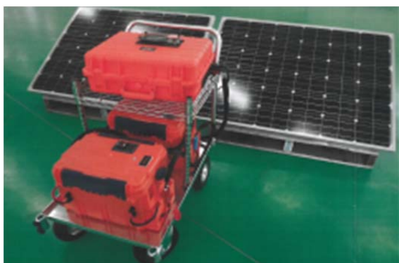
写真1 太陽光移動蓄電装置
