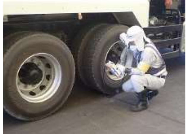
保管場からの退出車両の線量測定
