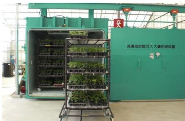
高濃度炭酸ガス大量処理装置
