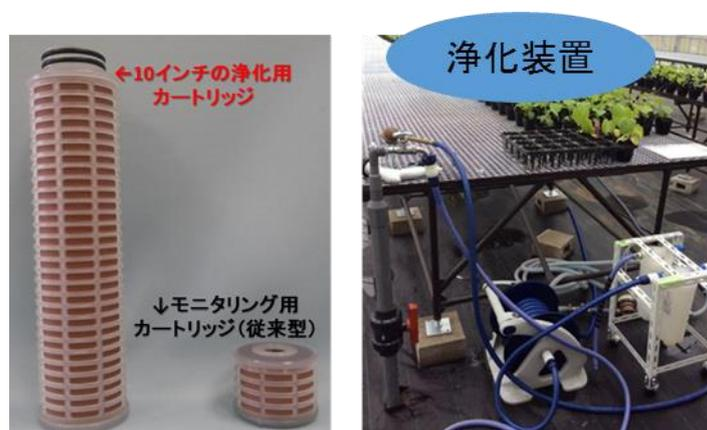
写真 1 浄化装置と浄化用カートリッジ
