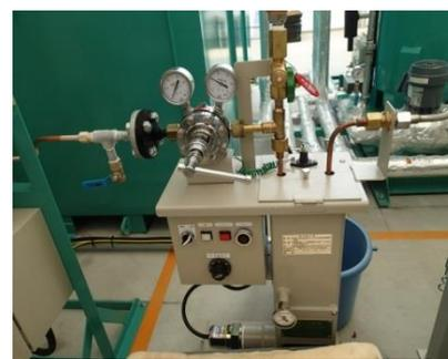
図7 炭酸ガス気化器
