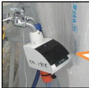
電磁弁付きタイマーは設定された時間になると、自動的にスイッチを入切するため、灌水を自動化することができます。
