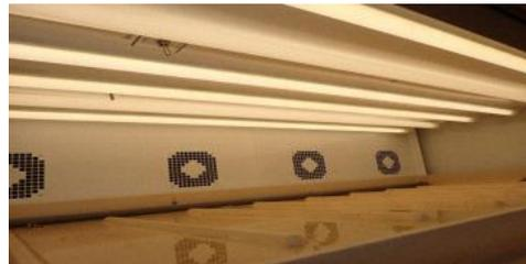
電球色 LED に UV-FL を加えたハイブリット LED 照射装置
