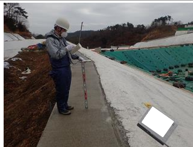
埋立地周辺における空間線量率の測定
