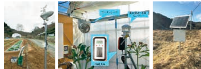
スマート電柵システムの現地試験 可搬型デバイス HALKA による遠隔監視制御システム フィールド WiFi システム
