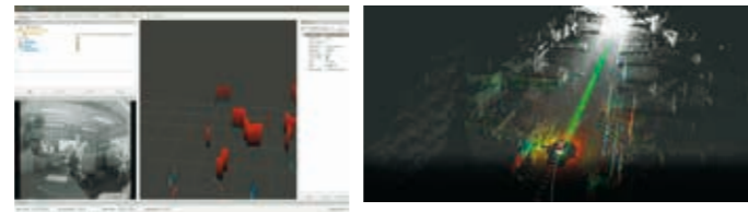
Velodyne及びAutowareによる現地試験(グレースケールの点群データは事前取得されたデータ、カラーの点群データは車載したレーザーキャナからのデータ)
