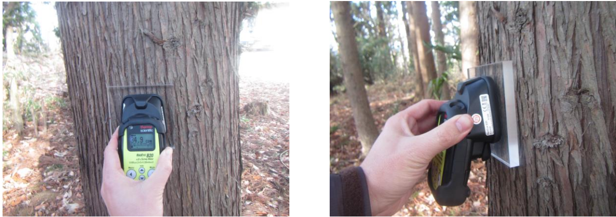
写真1 野外における GM 管式サーベイメータ (RadEye-B20) を用いた測定状況 (左: 正面、右: 側面)
