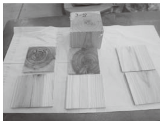
図-2 表面切削後の試料
