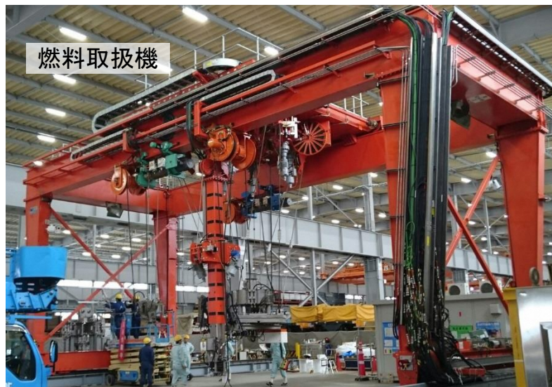
燃料取扱機動作確認状況 (撮影日2017年9月12日)
