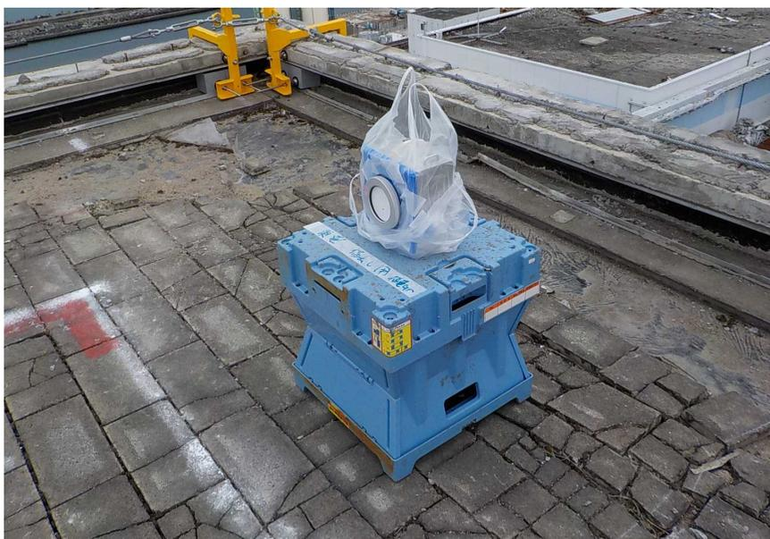
図1 有人作業時のダストサンプラーによるダスト測定状況
