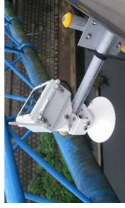
洪水に特化した低コストな水位計の設置例
